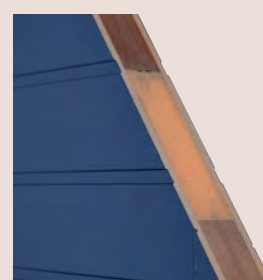
DETAIL ACHTERDEUR Isolerende kern
